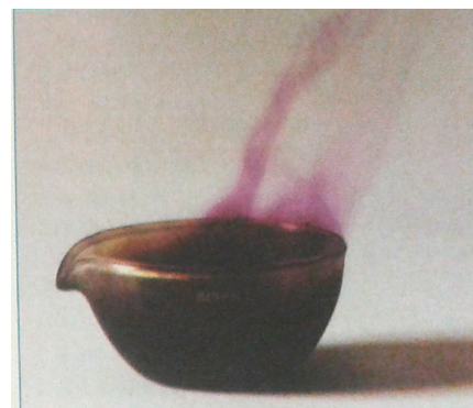
Fig. 4. Réaction entre le diiode et l'aluminium. On mélange du diiode I_2 (pilé dans un mortier) et de l'aluminium en poudre. La réaction se déclenche quand on ajoute quelques gouttes d'eau (catalyseur) ; elle forme du triiodure d'aluminium AlI_3 . Le dégagement de chaleur provoque l'apparition d'un nuage violet de diiode.
