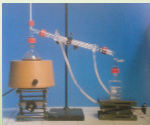
Fig. 1. montage d'entraînement à la vapeur d'eau de l'huile essentielle des fleurs de lavande. Le ballon contient des fleurs de lavande (ou autre produit organique naturel) et de l'eau. Il est relié à un réfrigérant descendant dont le rôle est de condenser les vapeurs qui y arrivent. Le produit obtenu s'appelle le distillat.
